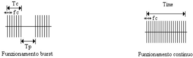
Fig. 9.2 – Corriente rectangular en funcionamiento burst tipo acción-pausa ( T.Contr. diverso de “CNT”) o in funcionamiento continuo ( T.Contr. = “CNT”)
